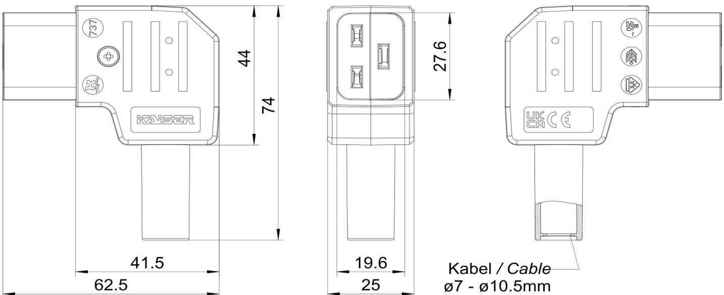
Abisolierung / Wire stripping: N 45 mm L 30 mm PE 45 mm
